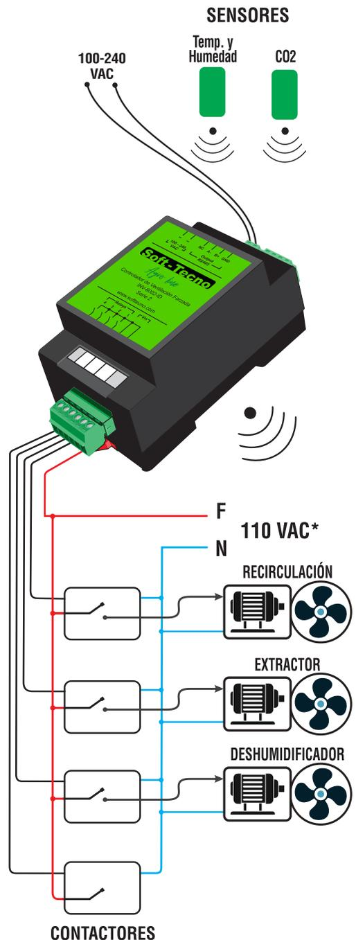
El diagrama de conexiones podría variar dependiendo del tipo de contactores y motores utilizados.
